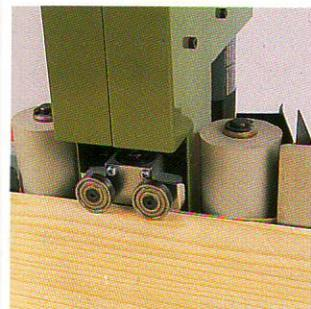
Perfilador motorizado: Perfilado del sobrante por ambas caras simultáneamente.
