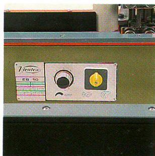
Regulación electrónica de la temperatura.
